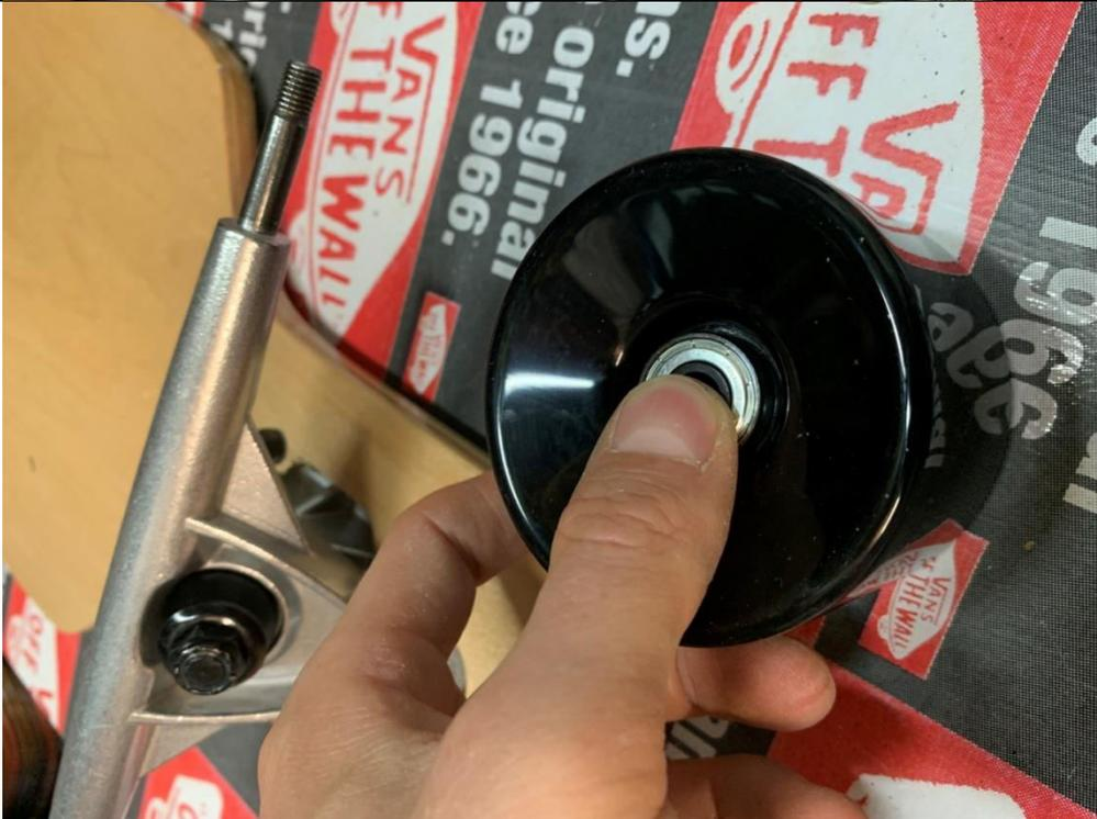
Das zweite Kugellager einsetzen und bis zum Anschlag in die Wheels drücken
