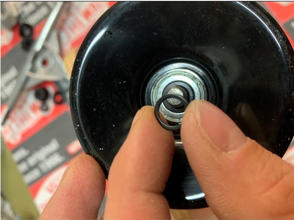
Und noch 1x Speedring **nach** der Longboard-Wheel/Rolle (vor der Truck Nut/Achsen Mutter)
