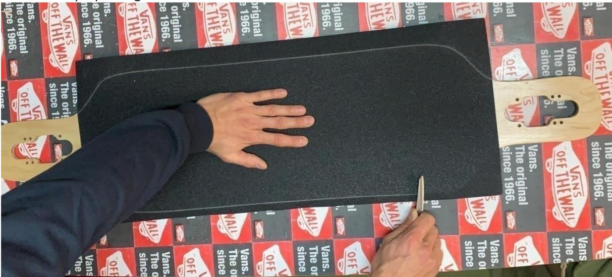
Mit einem Teppichmesser das überschüssige Griptape an den nun sichtbaren Schnittkanten abschneiden. Vorsichtig und möglichst nicht ins Holzfunier schneiden!
