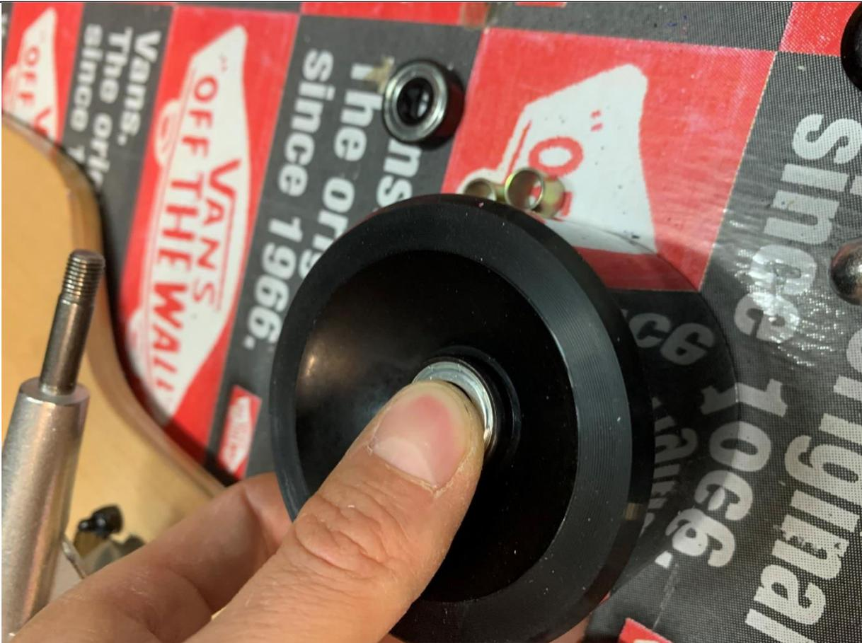
Das erste Kugellager einsetzen und bis zum Anschlag in die Wheels drücken
