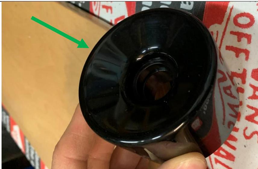
Longboard Wheels/Rollen besitzen eine Innen- und Außenseite. Die Außenseite erkennt man an der spitzeren Rollenkante
