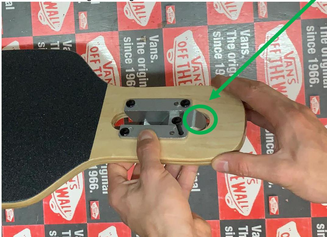
Von der Unterseite zuerst die **Montagescheiben** auf die Montageschraubenaufsetzen...
