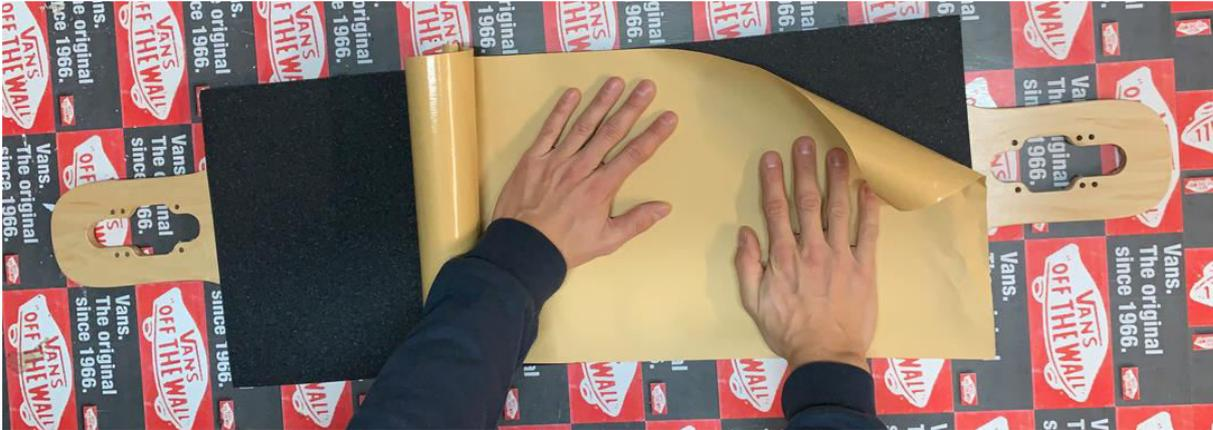
Mit einem Metallstab (z.B. Schraubenzieher, Schere, Brieföffner,...) wird entlang der Deckkante gefahren. Dadurch wird etwas Sand des Griptapes abgerieben und die Schnittkanten werden sichtbar.
