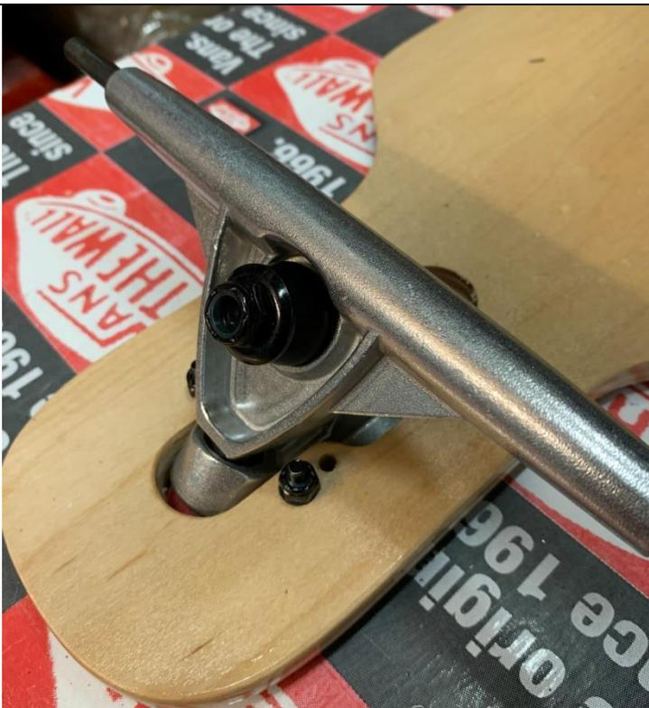
Fertig zusammengebaute Achsen
