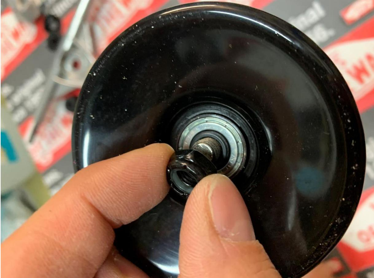
Truck Nut/Achsen Mutter aufsetzen und handfest anziehen. Danach wieder etwas lösen, sodass sich die Longboard Wheels frei drehen und somit rollen können.
